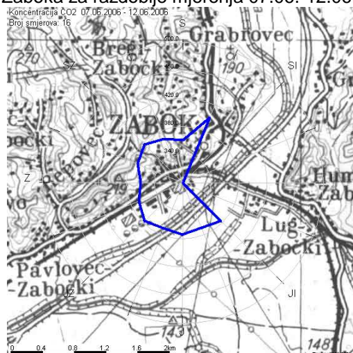
Slika 40: Prikaz srednjih imisijskih koncentracija CO 2 u odnosu na smjer vjetra na lokaciji Grada Zaboka za razdoblje mjerenja 07.06.-12.06.2006. (u µg/m 3 )
