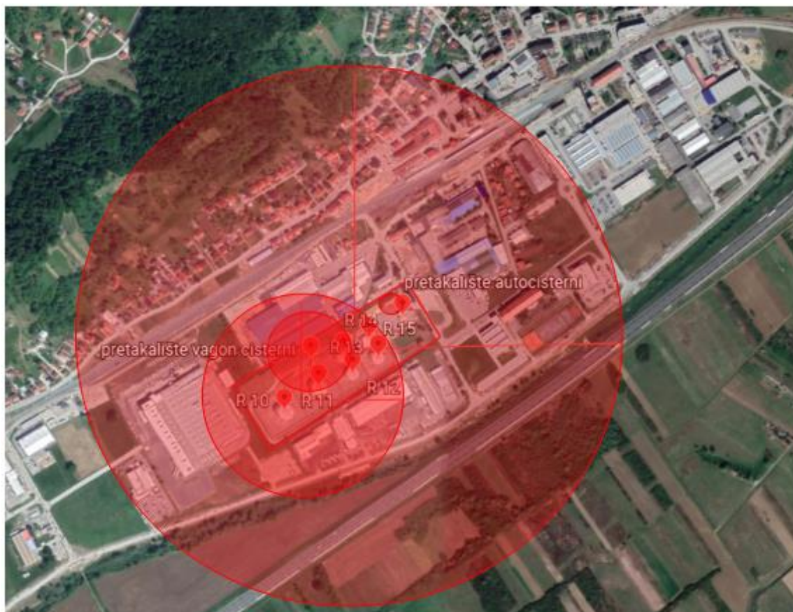
Slika 2. Krajnje zone ugroze po kritičnim točkama na području postrojenja Skladište i pretakalište naftnih derivata Zabok
