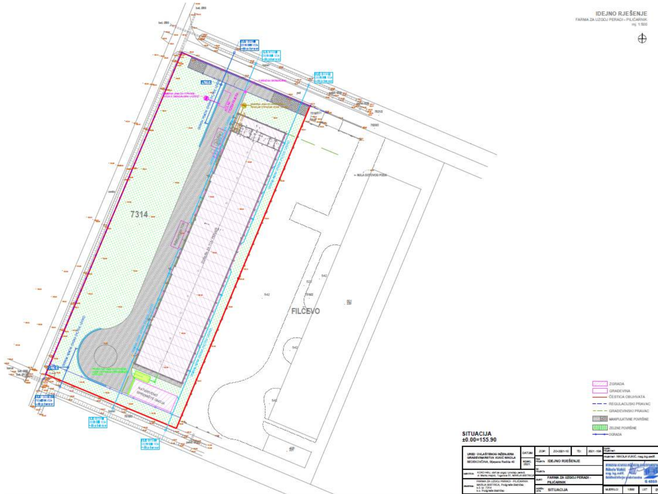
Prilog 13. Situacija internog sustava odvodnje otpadnih voda
