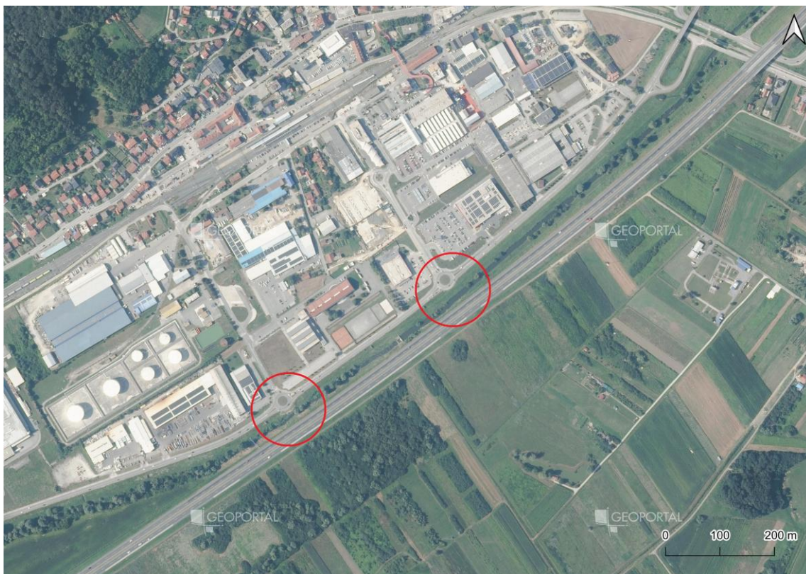
Sl. 2.2-2: Lokacije dva kružna toka na industrijskoj cesti gdje je vodotok sužen, a problem odnošenja dijelova pokosa je posljedica postavljenih kružnih tokova i njihove zaštitne obloge koja ulazi u profil vodotoka
